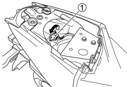
2. Tourner la douille ① dans le sens contraire des aiguilles d'une montre et la déposer.
