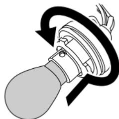
3. Appuyer sur l'ampoule, tourner vers la gauche et l'extraire.
