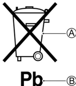
Le pictogramme représentant un bac à ordures barré d'une croix (A) sur l'étiquette apposée sur la batterie indique que la batterie doit faire l'objet d'une mise au rebut séparément des ordures ménagères. Le symbole chimique du plomb "Pb" (B) indique que la batterie contient plus de 0,004 % de plomb.
