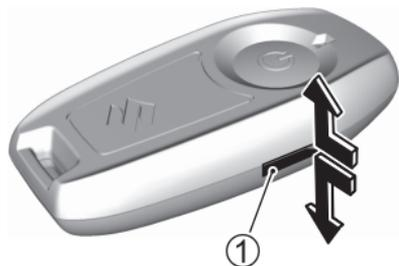
1. Séparez la partie supérieure de la télécommande de sa partie inférieure en appliquant une force sur la fente ① sur le côté de la télécommande.
