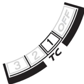
2. Fermer entièrement les gaz. Appuyez sur la commande de sélection ② (Haut ou Bas) pour sélectionner un mode.
