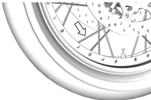
Resserrez les écrous de rayon correctement et uniformément au couple spécifié. Des écrous de rayon desserrés ou trop serrés vont se traduire par une tension inégale des rayons et une distorsion de la jante. Contactez votre concessionnaire Suzuki pour cet entretien.
