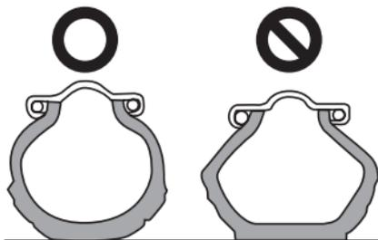
Vérifiez toujours la pression des pneus avant de prendre la route et assurez-vous que celle-ci est appropriée à la charge du véhicule comme le montre le tableau suivant.
