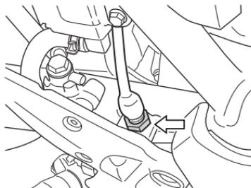
Pour régler le contacteur du feu stop, immobiliser le corps du contacteur et faire tourner le dispositif de réglage de sorte que le feu stop s'allume immédiatement avant que la pédale du frein ne commence à résister quand le pied appuie sur cette pédale.
