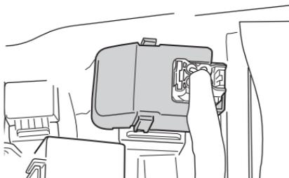
Le fusible principal est situé sous la selle. Pour accéder au fusible, déposer la selle en procédant comme indiqué en section VERROUILLAGE DE LA SELLE. Un fusible de réserve de 30A est situé dans la boîte de relais du démarreur.
